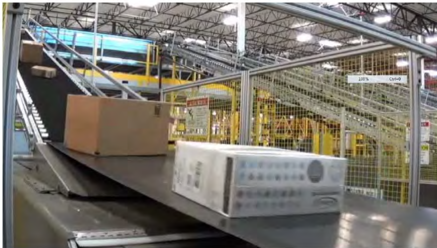
Figure 5 : Exemple de système de convoyage des colis
