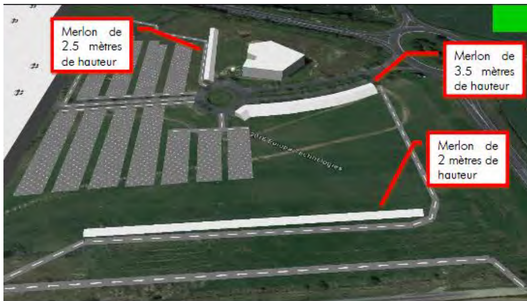
Figure 19 : Disposition des merlons sur le site
